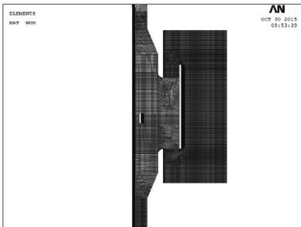
图4 热压罐几何模型局部网格划分
