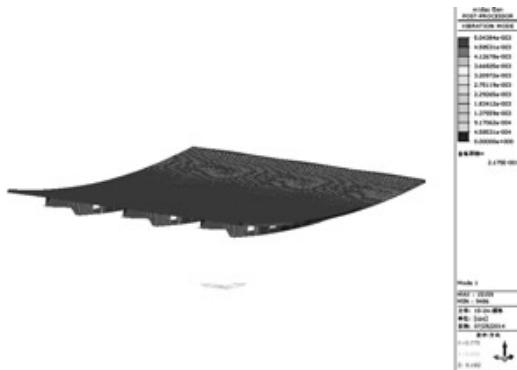
图16 MIDAS自振频率计算结果
