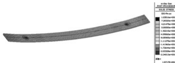
图14 组合钢梁混凝土板顶应力图
